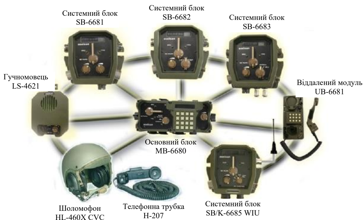
Рисунок 1 – Стандартна конфігурація цифрової системи внутрішнього зв'язку АСЕЛСАН 6680
